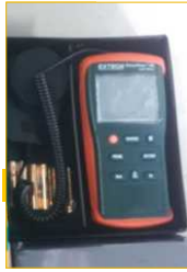
Lux Meter (mengukur besarnya intensitas cahaya lampu sarana)
