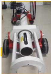
Hydraulic Axle Bearing (melepaskan dan memasang bearing)
