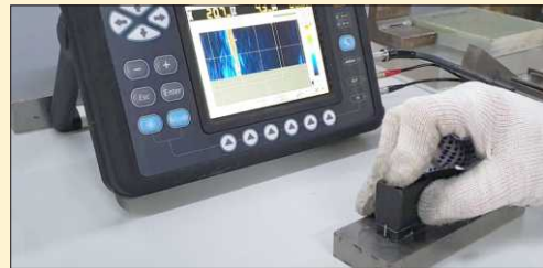
Ultrasonic Flaw Detector Pengukuran keretakan material
