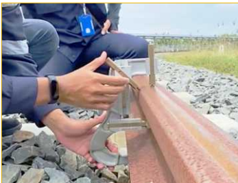
Alat Ukur Profil Rel, salah satu alat pendukung perawatan prasarana
