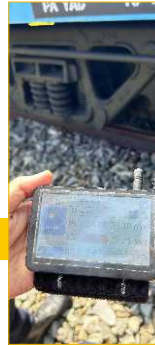
Wheel Profile Gauge Digital (Mengukur profil roda dengan sistem digital)
