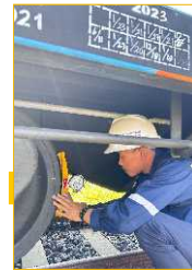
Penggunaan Wheel Diameter Analog secara praktis dan ringkas
