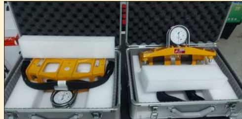
Wheel Diameter Analog berguna untuk mengukur jarak lebar roda pada sarana yang memungkinkan pembacaan langsung dengan menerapkannya pada tapak roda.
