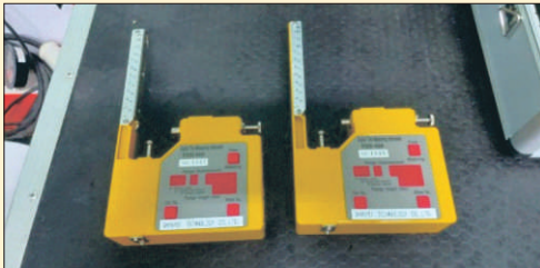
Wheel Profile Measurement Digunakan untuk mengukur profile roda pada kereta
