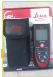
Meter Digital Laser (mengukur sarana dengan sistem laser)
