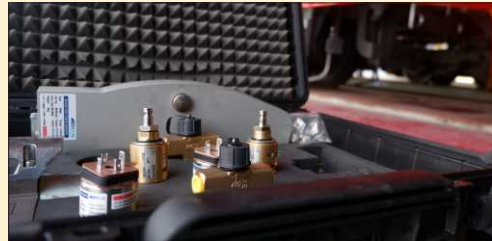
Test Bench Air Brake Sensor Pengukur tekanan angin pada pipa pneumatic saana perkeretaapian
