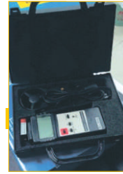
Anemometer / Humiditymeter (mengukur kelembaban udara pada kereta)
